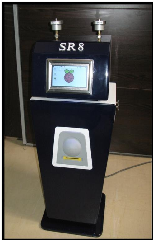
La colonna presenta un sistema a mensole sulle quali sono stati allocati i sensori di. A stabilizzare la struttura nella parte inferiore è stato posizionato l'UPS e tutta l'elettronica necessaria al funzionamento dei sensori, della trasmissione dati ed areazione dell'involucro.
